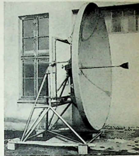
Bild 3. 3-m-Parabolantenne (Siemens & Halske)
