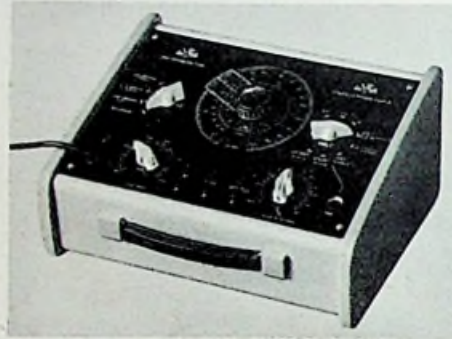
Bild 2. Außenansicht des RC-Generators Oszillographen OSP 3; Frontplatte für Bedienung im Stehen um 15° geneigt
