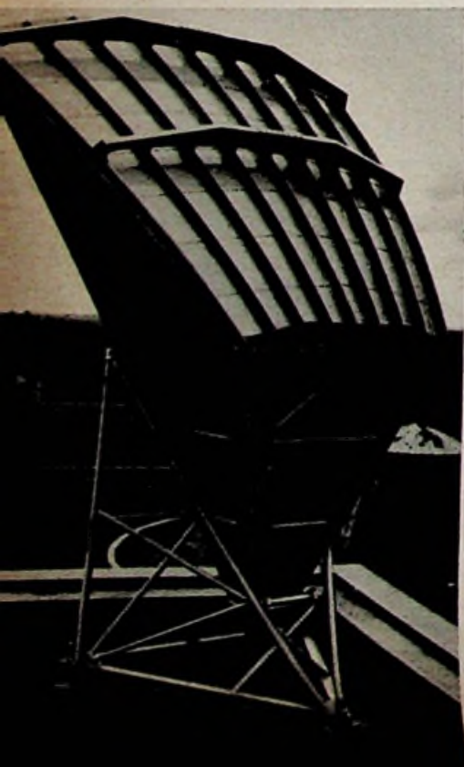
Links: Hornparabol-Antenne für 4000 MHz von Siemens & Halske
